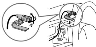
Asegúrelo mediante abrazaderas para cable (no suministradas) si fuera necesario.
