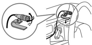
Se necessario assicurare con un fermacavo (non in dotazione all'apparecchio).
