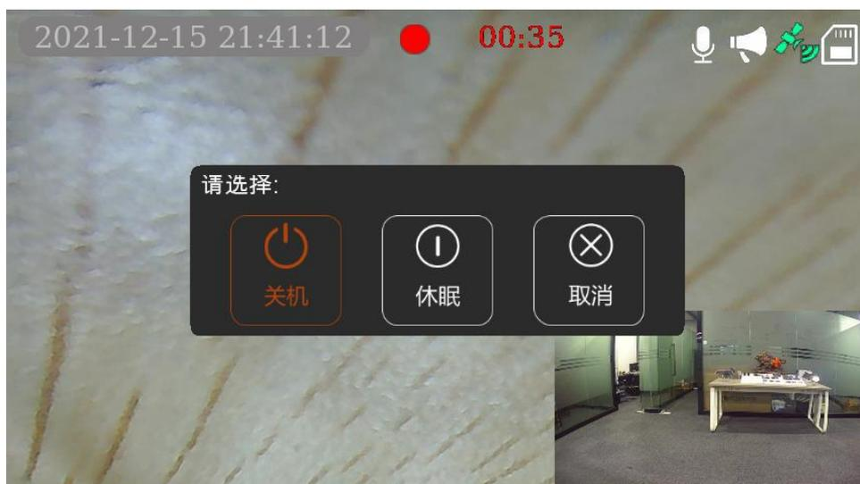
Después de apagar el encendido del automóvil, el dispositivo muestra un mensaje emergente "Seleccione lo siguiente:", El valor predeterminado es "Apagar". Después de seleccionar "Suspensión" manualmente, el sistema entrará en el modo de suspensión, y la función de memoria estará disponible después de seleccionar "Apagar / Suspend".
